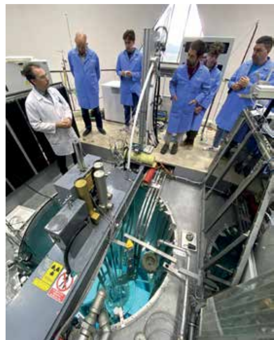
Pogled z vrha v bazen jedrskega reaktorja z gorivnimi celicami
