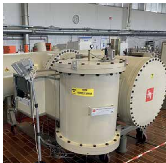
Začetek in konec (spodaj) ionskega pospeševalnika kjer se ukvarjajo z analizo sestave materialov.
